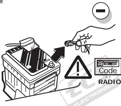
(DE) Um Störungen und Schäden am Bordnetz zu vermeiden, muss die Massepolklemme unbedingt vor Beginn aller Arbeiten von der Fahrzeughilfsbatterie getrennt werden! Insbesondere bei Arbeiten und Anschlüssen am CAN-Datenbus kann bei nicht abgeklemmter Batterie sowohl das Anhängermodul als auch das fahrzeugsseitige Bordnetzsteuergerät beschädigt werden! Bitte Herstellervorschriften beim Ab- und Anklemmen der Fahrzeughilfsbatterie beachten!
